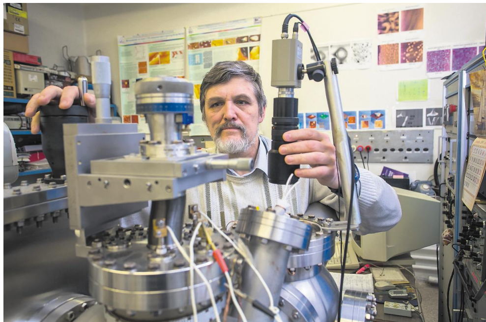
Старший научный сотрудник Института физики полупроводников кандидат физико-математических наук Сергей Тийс настраивает установку молекулярно-лучевой эпитаксии соединений АЗВ5.
